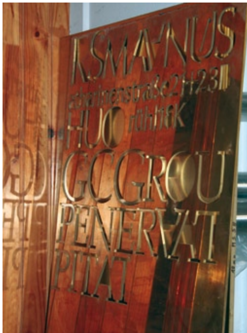
... Messing und Bronze – ein ideales Umfeld für den Wasserstrahl.
